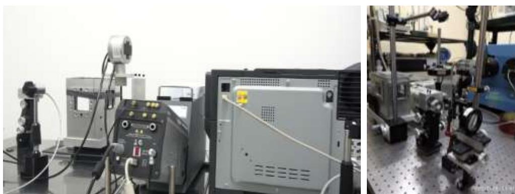
Gambar 2. 6. Spektroskopi menggunakan laser Nd-YaG di Laboratorium Gelombang, Optik, dan Aplikasi Laser Departemen Fisika.
