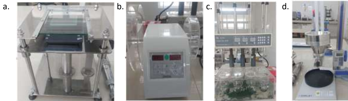
Gambar 2. 19. Instrument penelitian dalam bidang kefarmasian, a. Alat uji daya sebar dan daya lekat; b. Friability tester; c. Disolution tester; dan d. Granule flow tester.
