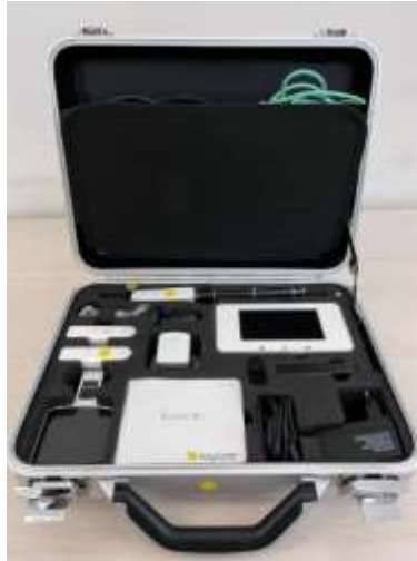
Gambar 2. 11. Multimeter X-Ray (Raysafe) di Laboratorium Fisika Medis dan Aplikasi Nuklir Departemen Fisika.
