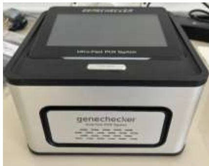
Gambar 2. 15. Genechecker Ultra-Fast PCR System Model UF-300 di Laboratorium Genetika dan Biologi Molekuler Departemen Biologi.
